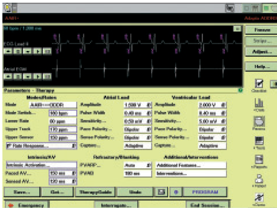
Obř. 3. TherapyGuide: Po stisknutí tlačítka „Get Suggestions“ se objeví obrazovka se základními parametry programace. Navržené změny jsou orámovány modře.
