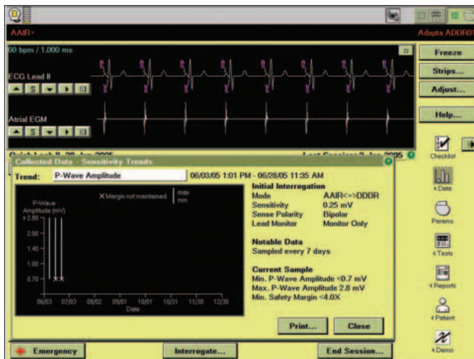
Obr. 6. Průběh měření síňového sensingu v situaci, kdy opakovaně není dodržen bezpečnostní limit algoritmu „sensing assurance“.
