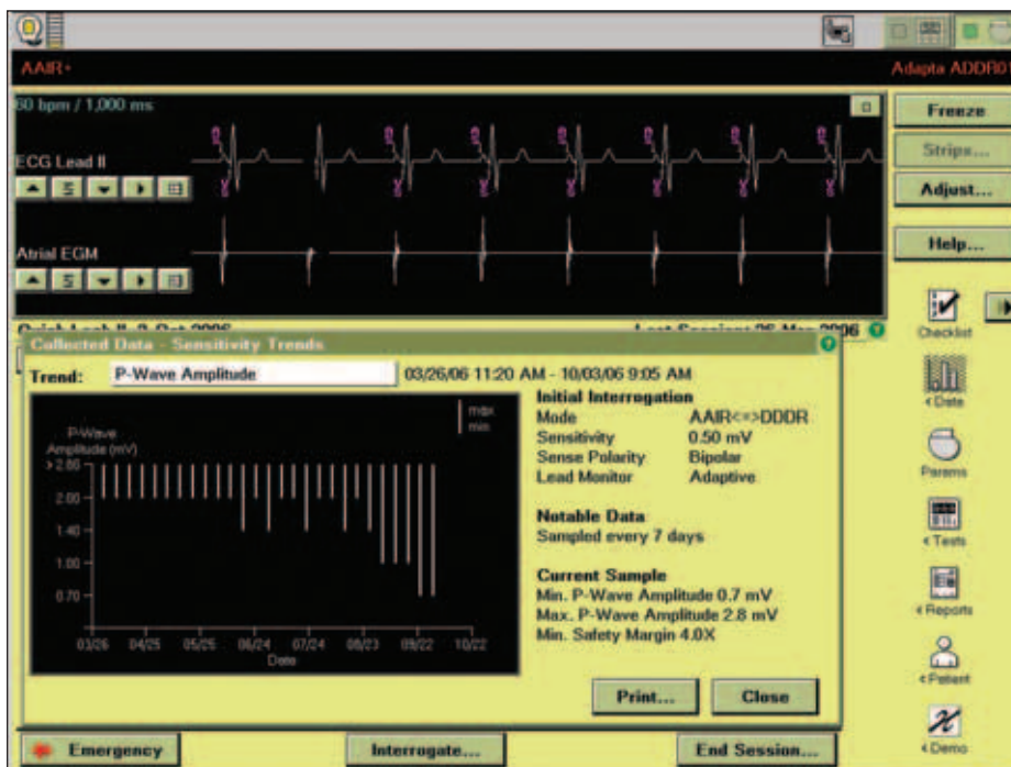
Obr. 4. Průběh měření síňového sensingu.
