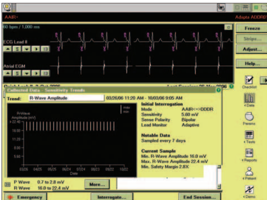
Obr. 5. Průběh měření komorového sensingu.
